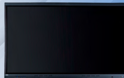
Tecnología de visualización DLED (retroiluminación directa mediante LED) 4K UHD 3840x2160 px
